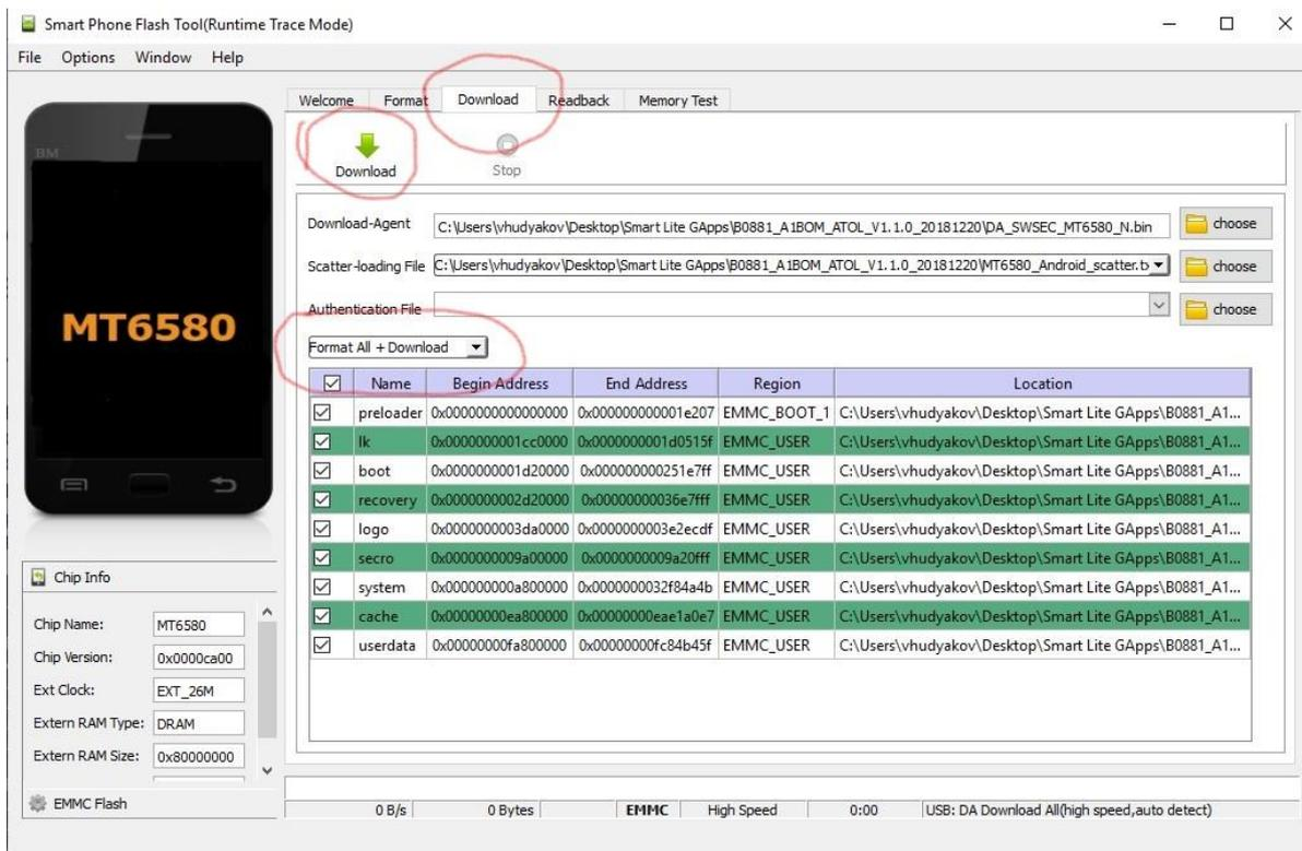
6. Подключаем ТСД к ПК, напомним, что он должен быть без аккумулятора в этот момент, нажимаем кнопку Download в программе прошивки и включаем ТСД. В момент определения программой ТСД нужно будет вставить аккумулятор обратно в ТСД для продолжения самой прошивки устройства. Так сложно потому, что питания от USB хватает только на запуск платы, но не хватает на саму операцию прошивки, поэтому в момент прошивки нужно вставить аккумулятор.
